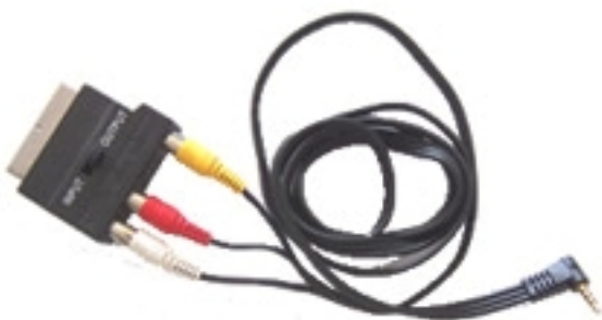
Figura 8 - Il cavo A/V connesso al presa scart che può generare un segnale in uscita
