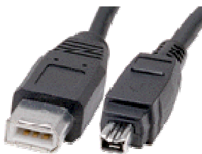
Figura 3 - I due tipi di connettore del cavo IEEE-1394 che possono connettersi a un PC
